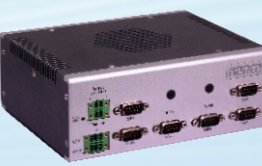
BIS-6670H 嵌入式准系统 基于Intel H110芯片组, 支持Intel 6/7代 Core i3/i5/i7 LGA1151 处理器的嵌入式准系统
