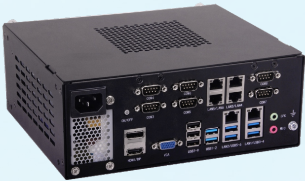
EPC-3130M-A10 嵌入式准系统 基于Intel H420E/Q470E芯片组 支持Intel 10代 Core i3/i5/i7 LGA1200 65W处理器的嵌入式准系统
