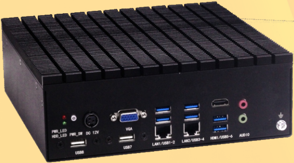
BIS-6675FT-A10 嵌入式准系统 基于飞腾D2000 处理器的嵌入式准系统
