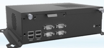
BIS-6665A31 多网口嵌入式准系统 基于Intel H110芯片组, 支持Intel 6/7代I3/I5/I7处理器 的嵌入式准系统
