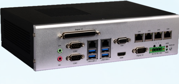
BIS-6665I-C10 嵌入式准系统 基于Intel H310芯片组 支持Intel 8/9代 Core i3/i5/i7/i9 LGA1151 处理器的嵌入式准系统
