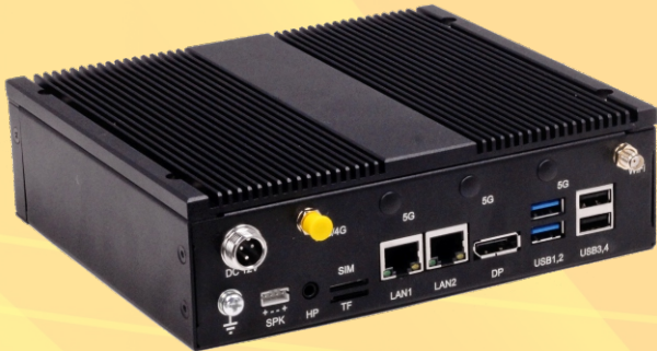
BIS-6360FT-A10 嵌入式准系统 基于飞腾E2000Q处理器的嵌入式准系统
