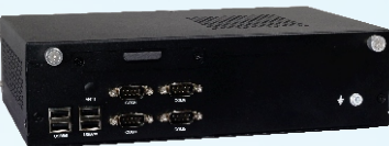
BIS-6665I-C10 嵌入式准系统 基于Intel H310芯片组 支持Intel 8/9代 Core i3/i5/i7/i9 LGA1151 处理器的嵌入式准系统
