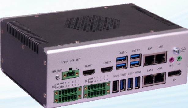
BIS-6670H 嵌入式准系统 基于Intel H110芯片组, 支持Intel 6/7代 Core i3/i5/i7 LGA1151 处理器的嵌入式准系统
