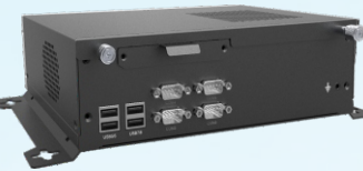
BIS-6665B31 多U口嵌入式准系统 基于Intel H110芯片组, 支持Intel 6/7 I3/I5/I7代处理器 的嵌入式准系统
