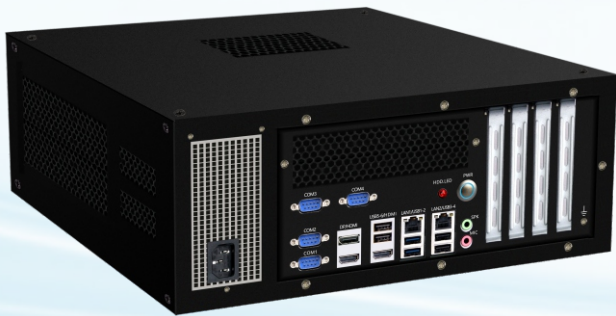
EPC-3206P 嵌入式准系统 基于Intel Q670E/Z690芯片组 支持 Intel 12/13/14代 Core i3/i5/i7/i9 处理器的嵌入式准系统
